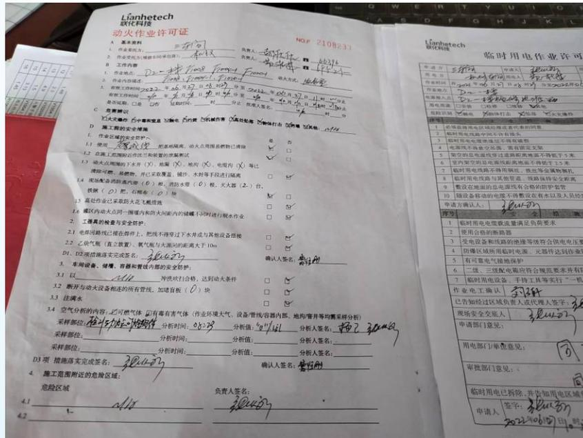
2022年6月27日E区三车间D2一楼的F1008、F1004-1、F1020-1三个过滤器安装作业，F1008过滤器与其他两处过滤器间距约15m，作业前仅对一处动火点作了可燃气体分析，未对另一处动火点开展检测分析工作。
