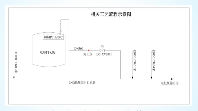
隔离阀门开启,低压外输汇管中的 LNG从切割开的管口中喷出
