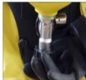
7、逆时针打开气瓶阀门 呼吸顺畅后进行作业
