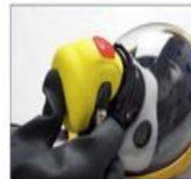
9、按住供气阀底部排出残余空气
