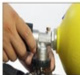
1、将气瓶阀门和减压器阀门连接
