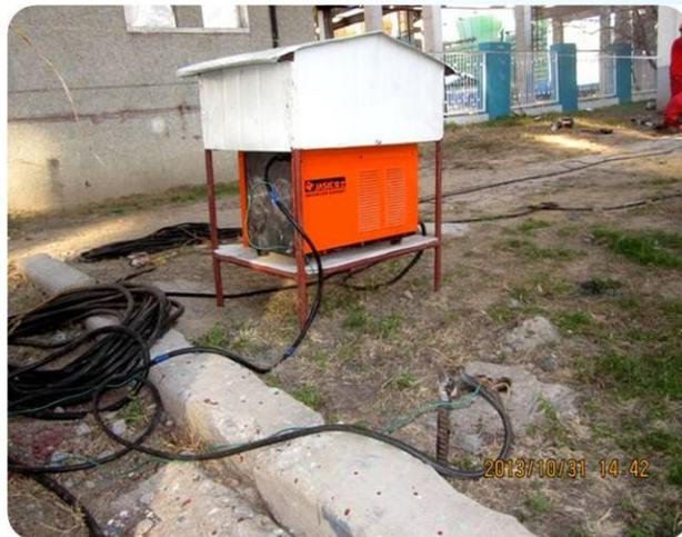
采用螺纹钢作为电焊机外壳接地体
